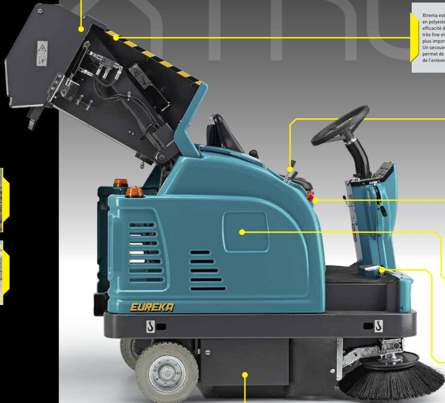
Le bac à déchets "multi-niveau", positionné sur la partie arrière de la machine, peut être hydrauliquement soulevé jusqu'à 1.360 mm du sol et a une capacité de 150 litres.
