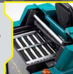
La pression au sol de la brosse centrale peut être réglée pendant l'utilisation, grâce à un dispositif positionné sur le tableau de bord.
