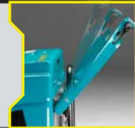
La tracción puede ser activada por medio de una cómoda palanca situada en el manubrio del operador.
