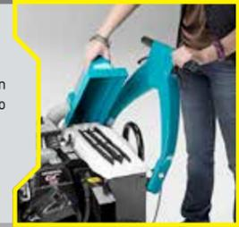
El polvo más fino es filtrado por un filtro de saco de poliéster con un excelente grado de filtración (99,9%) y tiene una duración mucho más larga que la de los filtros tradicionales. El filtro se limpia por medio de un eficaz sacudidor mecánico.
