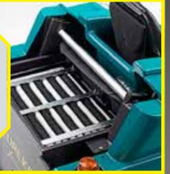
Der Anpressdruck der Kehrwalze kann während dem Reinigen dank eines exklusiven und genauen Reglers neben der Lenkung verändert werden.
