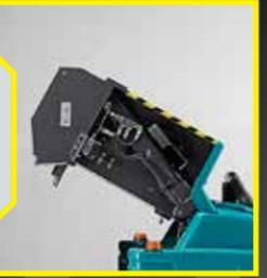
Xtrema ist mit einem Taschenfilter aus Polyester ausgerüstet, der sich speziell gut für Feinstaub eignet; er weist eine längere Lebensdauer auf als herkömmliche Filter. Der elektrische Filterschüttler sorgt für eine perfekte Reinigung des Filters ohne diesen herausnehmen zu müssen.
