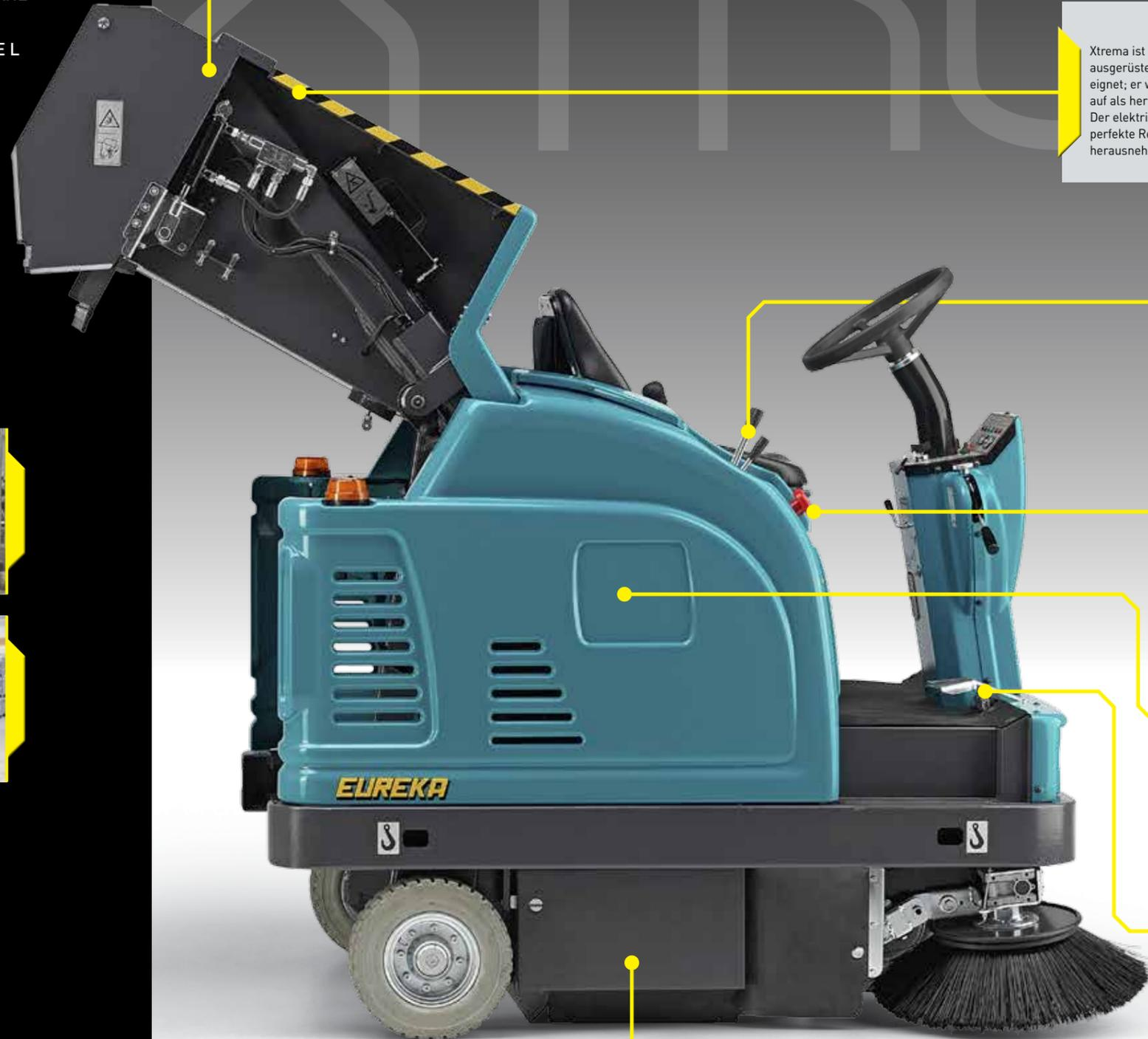
Der Schmutzbehälter mit mehrstufiger Hochentleerung ist mit einer hydraulisch kontrollierten Klappe versehen und befindet sich auf der Hinterseite der Maschine; er kann hydraulisch bis auf 1.360 mm vom Boden angehoben werden und hat ein Fassungsvermögen von 150 Litern.
