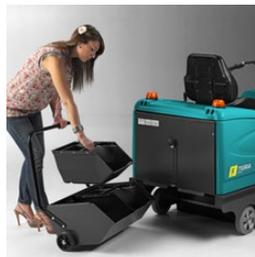
Positionné à l'arrière de la machine, le bac de déchets offre une capacité effective de récolte de 63 litres (ou 83Kg). Il est en acier, monté sur des roues et doté d'une poignée pratique pour le transport durant les opérations de vidange du bac. Les tiroirs réducteurs optionnels rendent la vidange encore plus simple.
