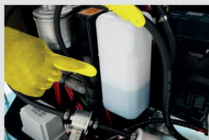
3. Controllare il livello del liquido di raffreddamento.
