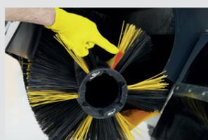
3. Controllo usura della spazzola centrale e laterale/laterali (compresa spazzola estensibile optional), se necessario registrarle correttamente o sostituirle.
