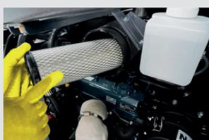
1. Controllare la pulizia del filtro dell'aria del motore.
