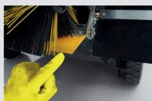
2. Controllo stato di usura o rottura delle gomme para polvere.
