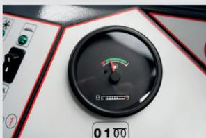
1. Controllare il livello del carburante nel serbatoio.
