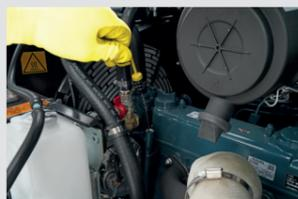
2. Controllare il livello dell'olio nel motore.
