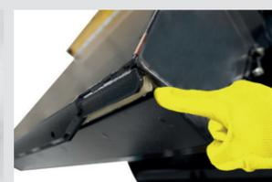
4. Verifica che le guarnizioni di chiusura del contenitore siano integre ed in buono stato.
