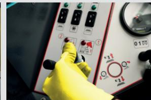
5. Sollevare il contenitore dei rifiuti utilizzando l'apposita leva fino all'altezza di scarico desiderata, ricordando che l'altezza max. di scarico è di 1580 mm.
