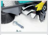
2. Usura della spazzola centrale e laterale/ laterali. Se necessario registrarle correttamente o sostituirle.
