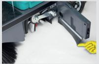
1. Stato di usura o rottura delle gomme parapolvere.
