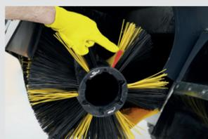
3. Prüfen Sie bitte den Zustand der Hauptkehrwalze und der Seitenbesen (einschließlich des optionalen ausfahrbaren Seitenbesens). Wenn nötig, stellen Sie die Besen ein oder ersetzen Sie diese.
