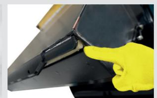
4. Die Verschlussdichtungen vom Kehrgutbehälter sollen unversehrt und in gutem Zustand sein.
