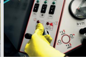
5. Den Kehrgutbehälter bis zur gewünschten Höhe heben (die max. Entladungshöhe beträgt 1.580mm).
