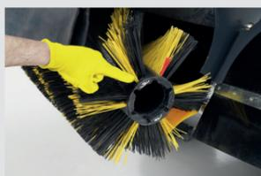
7. Prüfen und reinigen Sie die Hauptkehrwalze und die Seitenbesen (einschließlich des optionalen ausfahrbaren Seitenbesens): Es darf kein Seil oder Schnur etc. um die Bürsten gewickelt sein und die Borsten sollten in perfektem Zustand sein.
