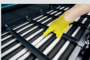
5. Prüfen Sie den perfekten Zustand des Staubfilters.
