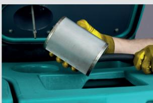
2. Den Filter des Saugmotors reinigen .
