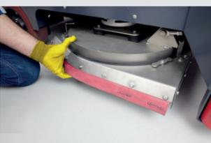
6. Den Spritzschutz sowie den Verschleißzustand der Sauglippen des Spritzschutzes überprüfen.
