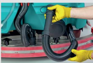
7. Stellen Sie sicher, dass der Saugschlauch sowie der Ablassschlauch nicht beschädigt sind.
