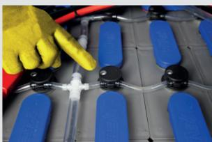
14. Nach dem Aufladen der Batterie bitte den Elektrolytstand überprüfen und wenn nötig mit destilliertem Wasser auffüllen. (Nur anzuwenden bei Nass-Batterien, die sich öffnen lassen).
