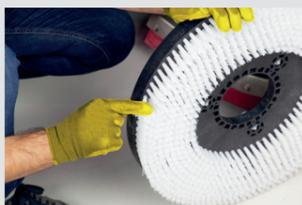
4. Die Bürstenreinigung und die Abnutzung überprüfen. Wenn die Borstenlänge die rote Verschleißanzeige erreicht hat, ersetzen Sie die Bürste
