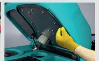
5. Stellen Sie sicher, daß die Deckeldichtung vom Schmutzwassertank in perfektem Zustand ist.
