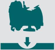
1. Bringen Sie die Maschine in einen Bereich, an dem man das Schmutzwasser ablassen kann und schalten Sie die Maschine aus.
