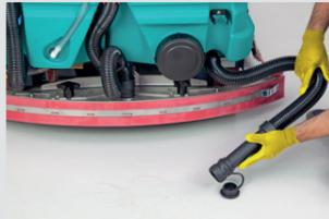
4. Entfernen Sie die Verschlusskappe des Rohrs und leeren Sie den Schmutzwassertank.
