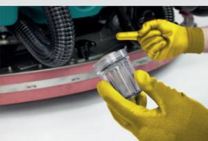
1. Den Reinigungslösungsfilter reinigen.
