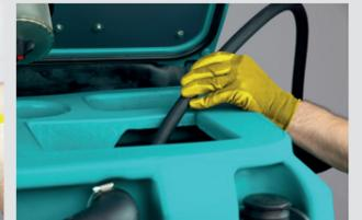
6. Den Schmutzwassertank ausspülen und die beiden im Tank sitzenden Schwimmer reinigen.
