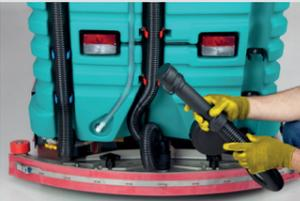
3. Entnehmen Sie den Schmutzwasserschlauch.
