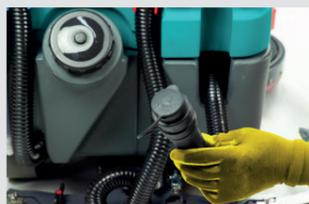
7. Stellen Sie sicher, daß der Saugschlauch sowie der Ablassschlauch nicht beschädigt sind.
