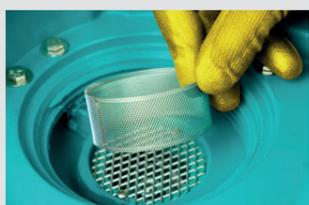
2. Den Filter des Saugmotors reinigen.
