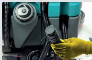
2. Entnehmen Sie den Schmutzwasserschlauch
