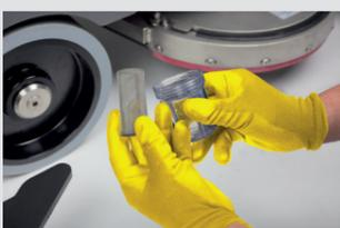
1. Den Reinigungs-lösungsfilter reinigen.
