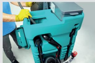
5. Den Schmutzwassertank ausspülen und den Schwimmer zur Abschaltung des Saugmotors reinigen.
