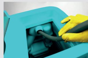
6. Den Saugschlauch wie auf dem Bild vom Tank aus nach unten durchspülen.
