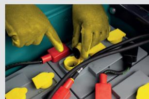
11. Nach dem Aufladen der Batterie bitte den Elektrolytstand überprüfen und wenn nötig mit destilliertem Wasser auffüllen. (Nur anzuwenden bei Nass-Batterien, die sich öffnen lassen).
