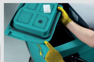
5. Stellen Sie sicher, daß die Deckel-dichtung vom Schmutzwassertank in perfektem Zustand ist.
