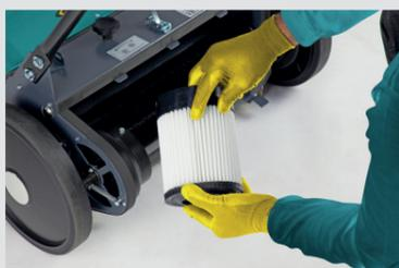
3. Integrità del filtro della polvere. (solo per modello 151 ECOVAC®)
