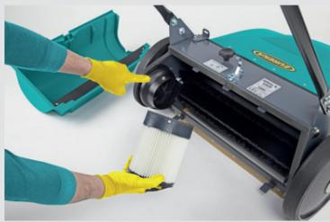
3. Rimuovere dalla macchina il filtro della polvere, pulirlo e riposizionarlo nell'apposita sede. (solo per modello 151 ECOVAC®)
