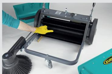
2. Usura della spazzola centrale e laterale. Se necessario registrarle correttamente o sostituirle.
