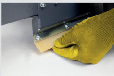
1. Stato di usura o rottura delle gomme parapolvere.
