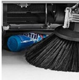
Il dispositivo "alza-flap" viene attivato direttamente dal posto di guida. Permette alla spazzola centrale di raccogliere anche i rifiuti più voluminosi ed ingombranti.
