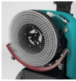
Pour une meilleure distribution, la solution nettoyante est déversée sur le sol à partir du centre de la brosse. Les 360mm de diamètre de la brosse permettent de nettoyer même les espaces les plus étroits et congestionnés.
