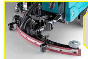
LE SUCEUR: Le dispositif de séchage est un point très important. Nos ingénieurs ont travaillé pour vous apporter une qualité optimale. Ceci limite les risques de glissade et les accidents. Le suceur de nos machines permet une aspiration totale de la solution. La qualité des matériaux employés, la courbure, la qualité des lamelles, la puissance de la turbine, les réglages du suceur vous garantiront un travail sans risque et une qualité irréprochable.
