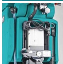
Il caricatore a bordo consente di ricaricare le batterie con facilità e in modo ideale. A seconda della tipologia di batterie installate, la macchina può essere ricaricata anche in ambienti poco areati.
