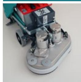
Robusto telaio in acciaio standard protetto con trattamenti ai fosfati di zinco, cataforesi e verniciatura a polvere. Nella versione Chrome® il telaio, il tergi pavimenti e le componenti meccaniche sono realizzate in acciaio INOX per lavorare e resistere in contesti altamente corrosivi.
