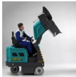
El depósito se encuentra situado en la parte delantera de la máquina y puede elevarse mediante un sistema hidráulico hasta una altura máxima de 1565 mm. El depósito es flotante y autorregulable, lo que facilita la recogida de residuos voluminosos.
