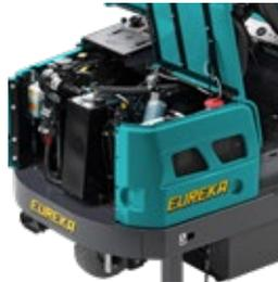
Todas las partes mecánicas internas de la barredora son de fácil acceso; con el objetivo de simplificar las operaciones de mantenimiento, todos los paneles se pueden abrir completamente (paneles traseros, laterales y superiores). Las baterías (en la versión EB EVOLUTION) se pueden reemplazar de manera sencilla y rápida.
