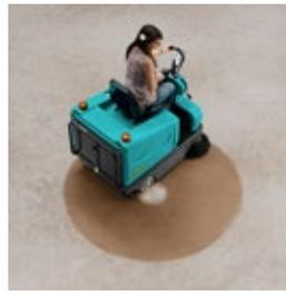
La barredora compacta Tigra tiene un radio de giro reducido (950mm), lo que permite la limpieza de espacios estrechos de difícil acceso.
