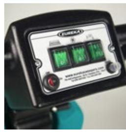
Para una seguridad añadida, la E46 tiene una llave de arranque. El motor del cepillo y el circuito eléctrico están protegidos por un fusible rearmable, que corta el suministro eléctrico si se detecta alguna anomalía.
