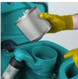
El motor de aspiración está protegido contra las impurezas gracias a un filtro extraíble de acero inoxidable, que se puede limpiar fácilmente.
