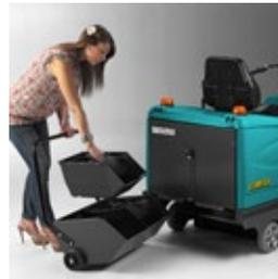
Der am Heck der Maschine positionierte Kehrgutbehälter hat eine Ladekapazität von 63 Litern (83 kg). Er besteht aus Stahl, ist auf Rädern montiert und mit einem bequemen Griff zum einfachen Transport und Entleeren ausgestattet. Die optionalen aushebbaren Schmutzbehälter machen das Entleeren noch einfacher.
