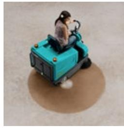
Die kompakte Kehrmaschine Tigra hat einen reduzierten Wenderadius (950 mm), was die Reinigung in engen und schwer zugänglichen Räumen ermöglicht.
