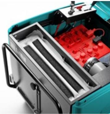
Mit einer innovativen Struktur, einer großen Filterfläche und einem Abscheidegrad von bis zu 99,9 % liefert der Multipocket Filter® saubere Luft zurück in die Umwelt und garantiert eine Filterleistung, die über einen längeren Zeitraum anhält. Der Filter ist außerdem waschbar, wasser- und ölbeständig, selbstreinigend und wartungsfreundlich.
