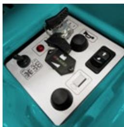
Alle Funktionen der Maschine, einschließlich des Zuges und der Steuerung der Bürsten und der Absaugung, werden über einfache und intuitive Bedienelemente gesteuert, die leicht zugänglich sind.
