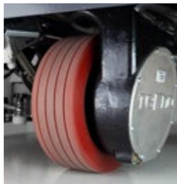
Der Antriebsmotor ist leistungsstark und zuverlässig und im vorderen Teil der Maschine aufrecht installiert. Das Vorderrad wird über ein Getriebe angetrieben, das geschmiert und abgedichtet ist, um es vor Stößen, Schmutz und Feuchtigkeit zu schützen.
