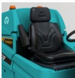
Der Sitz des Bediener ist mit Gewichtssensoren und einem Sicherheitsgurt ausgestattet, außerdem ist es möglich, im Notfall oder bei Wartungsarbeiten die Stromzufuhr abzuschalten, wodurch dem Bediener und den Mechanikern ein Höchstmaß an Schutz und Sicherheit garantiert wird.
