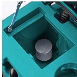
Die Konstruktion des Schmutzwassertanks mit einem Fassungsvermögen von 135 l erleichtert Entleerungs-, Reinigungs- und Desinfektionsvorgänge.
