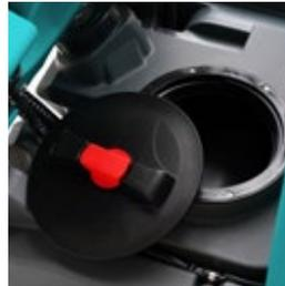
Der Lösungstank hat ein Fassungsvermögen von 120 L, was eine außergewöhnliche Laufzeit garantiert. Zwei praktische Bullaugen erleichtern das Nachfüllen, die Inspektion und die Reinigung.
