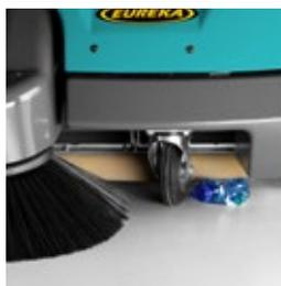
Il dispositivo "alza-flap", montato sulla parte anteriore dei modelli Kobra, facilita la raccolta di rifiuti voluminosi.
