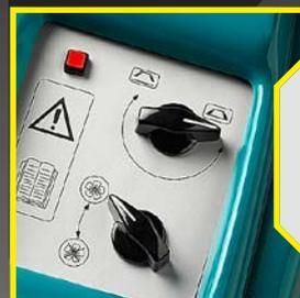
Il quadro comandi, posizionato sul cofano, è semplicissimo e con un comando di esclusione dell'aspirazione, un comando di sollevamento / abbassamento della spazzola laterale e un interruttore a chiave.
