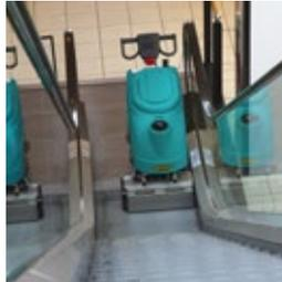
Sobald die Maschine positioniert wird, arbeitet sie automatisch. Der Bediener muss sie nur überwachen und kann sich in der Zwischenzeit anderen Reinigungstätigkeiten zuwenden.
