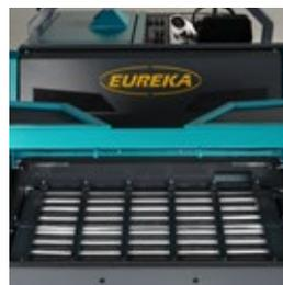
C'est un filtre antistatique, lavable, équipé d'un système de secouage automatique, qui garantit une filtration supérieure et constante.
