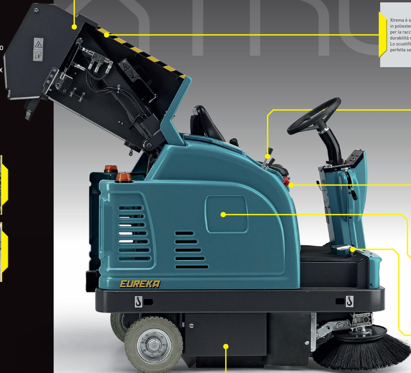
Il contenitore dei rifiuti, a scarico multi-livello, è dotato di portellone di apertura/chiusura a controllo idraulico. È situato sulla parte posteriore, può essere sollevato idraulicamente sino a 1.360 mm dal suolo ed ha una capienza di 150 litri.
