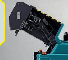
Xtrema è equipaggiata con un filtro a sacche in poliestere, che è particolarmente efficace per la raccolta di polveri fini ed ha una maggiore durabilità rispetto ai filtri tradizionali. Lo scuotifiltro elettrico garantisce una pulizia perfetta senza bisogno di rimuovere il filtro.
