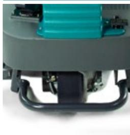
Il motore di trazione è sigillato e protetto da un robusto paracolpi tubolare in acciaio che integra in sé anche il dispositivo antiribaltamento. La gomma della motoruota è in poliuretano antitraccia e antiskid.
