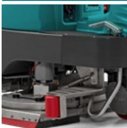
Telaio e dettagli in acciaio INOX. La versione Chrome® garantisce resistenza ad ossidazione e ruggine, data da contesti di lavoro corrosivi e detergenti aggressivi.
