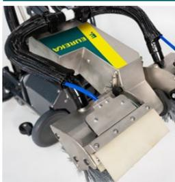
Il telaio in acciaio, la testa spazzole e il serbatoio di recupero in acciaio INOX, garantiscono grande resistenza nel tempo.
