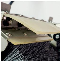
Die Rinne befindet sich direkt unter den Bürsten, fängt Tropfen der Lösung auf und ermöglicht eine gründliche Saugtrocknung. Polyurethan-Spritzschutzvorrichtungen verhindern Spritzer nach oben. Ergänzt und verbessert die Arbeit von Rolltreppenreinigern.
