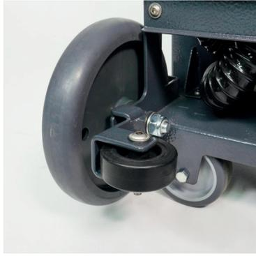
Der innovative GlideStep System® Mechanismus von Eureka ermöglicht es der Maschine, sich schnell und mühelos von einer Stufe zur nächsten zu bewegen. Durch dieses intelligente System entfallen die Zeiten, die für die manuelle Neupositionierung der Maschine benötigt werden. Der Bediener kann daher die gesamte Rolltreppe schnell und ermüdungsfrei reinigen.
